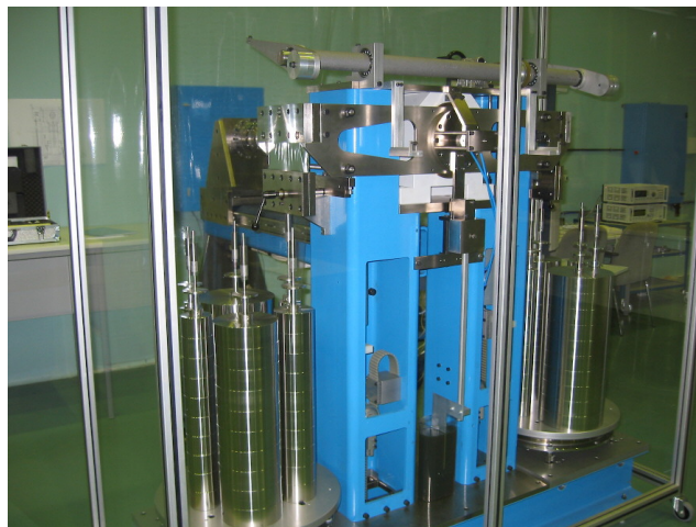
Figura 2. Máquina patrón de par de carga directa en el Centro Español del Metrología
